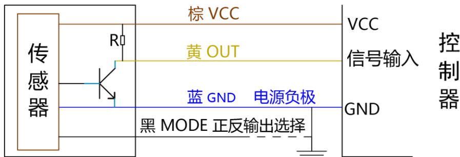
高低电平信号输出：连接控制器或MCU的接线方法
